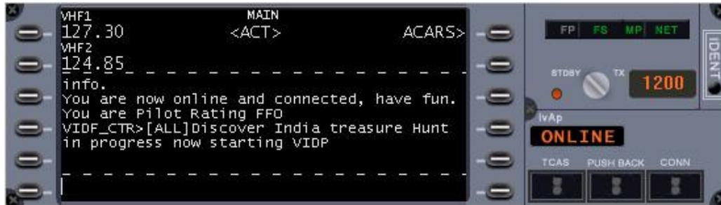
En cliquant en face de la fréquence VHF1 avec le bouton droit de la souris on va faire apparaître les fréquences en service. Il suffit de choisir celle de l'aéroport de départ, si le contrôle est actif, ou plus réaliste, utiliser la radio de l'appareil. Dans ce cas la fréquence active s'inscrira dans l'interface du programme Ivap, et on sera basculé sur la fréquence TS du contrôleur (si celui-ci utilise TS bien entendu.)
